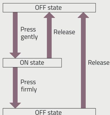
Il pulsante di abilitazione può essere fornito fino ad una combinazione di quattro contatti NO+NC a camere separate permettendo così di controllare in retroazione l'efficienza dei vari elementi.
