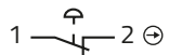
Pulsante rosso a fungo sferico Ø50 ad incasso Red palm push-button Ø50 wall-mounting
